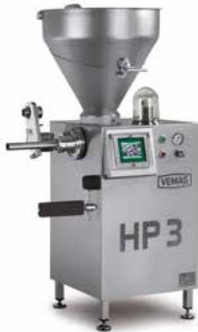
La HP3 es una máquina embutidora al vacío fiable y robusta con husillo para trabajos manuales, y se trata de la máquina embutidora al vacío más pequeña de VEMAG. La tolva se ha rediseñado completamente. Su forma optimizada mejora la introducción del producto y reduce al mínimo la acumulación de residuos en las paredes interiores de la tolva para una utilización óptima de las materias primas.
