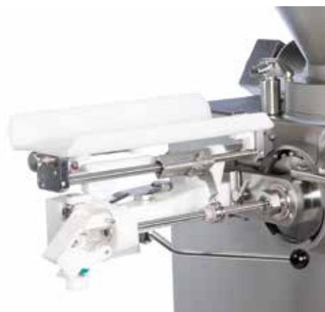
El dispositivo de sujeción de tripas DHV841 es un equipo suplementario para máquinas embutidoras al vacío y se acopla directamente al mecanismo de retorsión. A diferencia de sistemas similares, no requiere un accionamiento propio. Un empujador de tripa integrado de accionamiento neumático facilita el procesamiento de tripas artificiales. Un soporte de caddy, situado sobre el empujador de tripa, recoge los caddys de tripa corrientes en el mercado y realiza un trayecto corto en el cambio de tripa.
