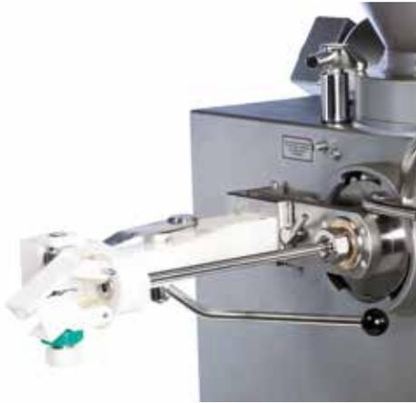
Ya se trate de tripa de cordero o tripa de cerdo, gracias al dispositivo de sujeción de tripas DHV937 la retorsión de salchichas de cualquier calibre resulta un juego de niños. Se acopla directamente al mecanismo de retorsión y no requiere un accionamiento propio. El freno de tripa se puede ajustar durante el funcionamiento, lo que permite la obtención de un producto óptimo y un manejo muy sencillo.
