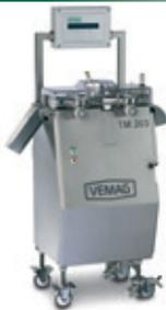
TM203 es una máquina de corte de alto rendimiento que realiza hasta 1.300 cortes/min. Su cuchilla de tres filos en forma de media luna corta las salchichas con precisión en el punto de torneado, incluso de productos curvados. La buena conducción sobre las cintas transportadoras así como el corte preciso de la cuchilla permiten obtener unos resultados de corte excelentes que resultarán visibles en sus productos.
