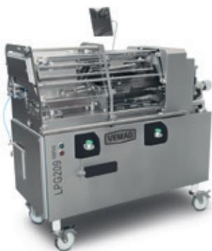
Rápida, innovadora y productiva: estos adjetivos describen la nueva máquina porcionadora de longitud constante LPG209 servo para todos los tipos de tripa. El depósito de tripas integrado reduce los tiempos de cambio de tripa e incrementa la capacidad de producción, que puede alcanzar las 2.200 salchichas al minuto. El dispositivo de sujeción rápido para las cintas de división minimizan los tiempos de preparación.
