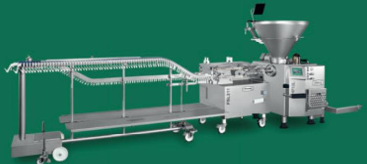
Una línea flexible para producir y colgar salchichas de igual longitud de todo tipo compuesta de HP10E, FSL211 y AH212.
