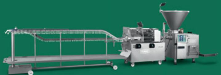
La variante de alta velocidad para una mayor automatización, p. ej., de salchichas crudas y snacks en tripa artificial o de colágeno. Consta de una máquina embutidora al vacío de la serie HPE, la máquina porcionadora de longitud constante LPG209 servo y la máquina de colgar AH212.
