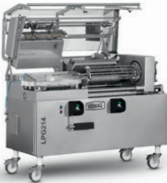
La máquina porcionadora de longitud constante dispone de un depósito de tripas automático con tiempos de cambio de tripa inferiores a 2,5 seg; para aumentar la productividad por hora, la LPG214 está equipada con tubos de retorsión prolongados, lo que permite utilizar tramos de tripa más largos. Con esta novedad se consigue un aumento del tiempo productivo y se minimizan los tiempos muertos.
