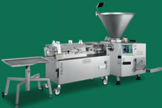
Una línea para porcionar, retorcer y cortar salchichas con máxima flexibilidad y que se compone de una máquina embutidora al vacío de la serie HPE y la Flexible Sausage Line FSL210.
