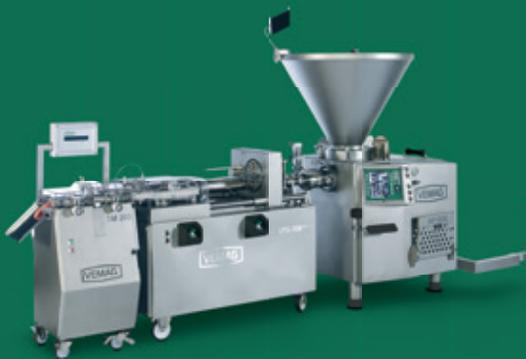
Este equipo industrial de alto rendimiento consta de máquina embutidora al vacío de la serie HPE, el servoaccionamiento de la máquina porcionadora de longitud constante LPG208 servo y la máquina de corte TM203 para retorsionar y cortar salchichas como, p. ej., salchichas frescas para freír.
