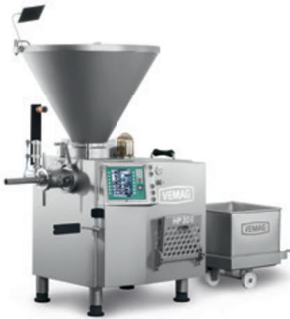
La HP25E es la máquina embutidora al vacío de la serie HPE más rápida del mercado destinada a la fabricación de productos para lonchas de gran tamaño. Gracias al intercambio flexible del husillo, la máquina se puede transformar con pocas maniobras para su producto. Esto no solo permite ahorrar costes, sino también tiempo.
