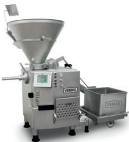
La HP10L es una máquina especializada en retorsión que a la vez mantiene su flexibilidad por el husillo de alimentación. La solución para todos los trabajos de embutido en la producción de salchichas sin picadora-embutidora. Su gran capacidad queda patente con dispositivos de sujeción de tripas o las líneas de salchichas flexibles de VEMAG. De esta forma, la retorsión y el porcionado de masas blandas no pueden ser más fáciles.
